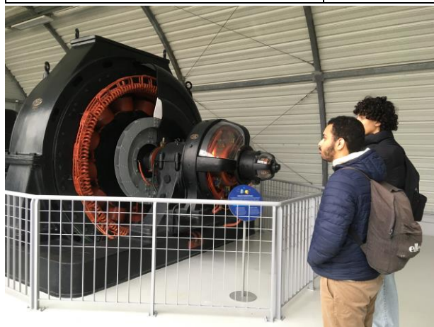
Alternateur du groupe hydroélectrique de la centrale de la Perrière-Vignotan (Alpes) 600 kW en pleine puissance Electropolis 2024
