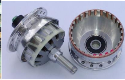
Alternateurs de bicyclette 1 W dans le moyeu
