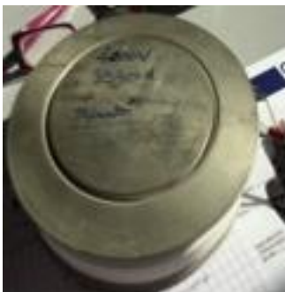
1970 : Thyristor 5 kg ; 4 000 V ; 3940 A f_{\max} = 100 kHz
