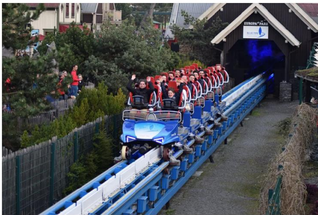
Figure 4 – Lancement d'un train, les modules du stator sont les plaques blanches verticales
