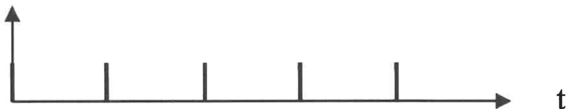
Figure 3 - Train d'impulsions à l'émission en E (fréquence f_E et période T_E = 1/f_E )
