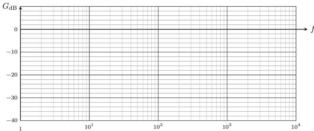
Le gain en décibel est donné par la relation  $G_{\text{dB}} = 20 \log\left(\frac{U_{\text{sortie}}}{U_{\text{entrée}}}\right)$ .
