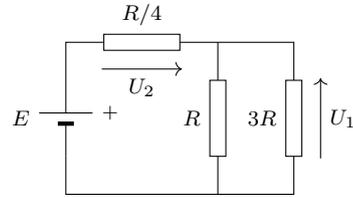
a) Calculer la résistance équivalente aux deux conducteurs ohmiques en parallèle. ....
