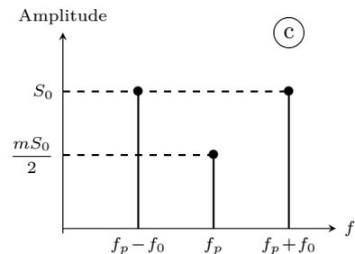
c) Donner l'amplitude de la composante de fréquence  $f_p$  de  $s(t)$  .....
