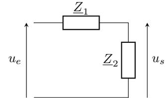
Nous souhaitons écrire la fonction de transfert du filtre  $\underline{H}(j\omega) = \frac{u_s}{u_e}$  sous sa forme canonique :
