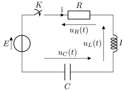
À  $t = 0$ , on ferme l'interrupteur  $K$ .
