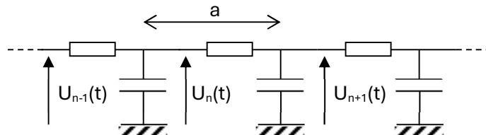
La loi des nœuds permet de montrer que les tensions  $U_{n-1}$ ,  $U_n$  et  $U_{n+1}$  sont liées par l'équation :
